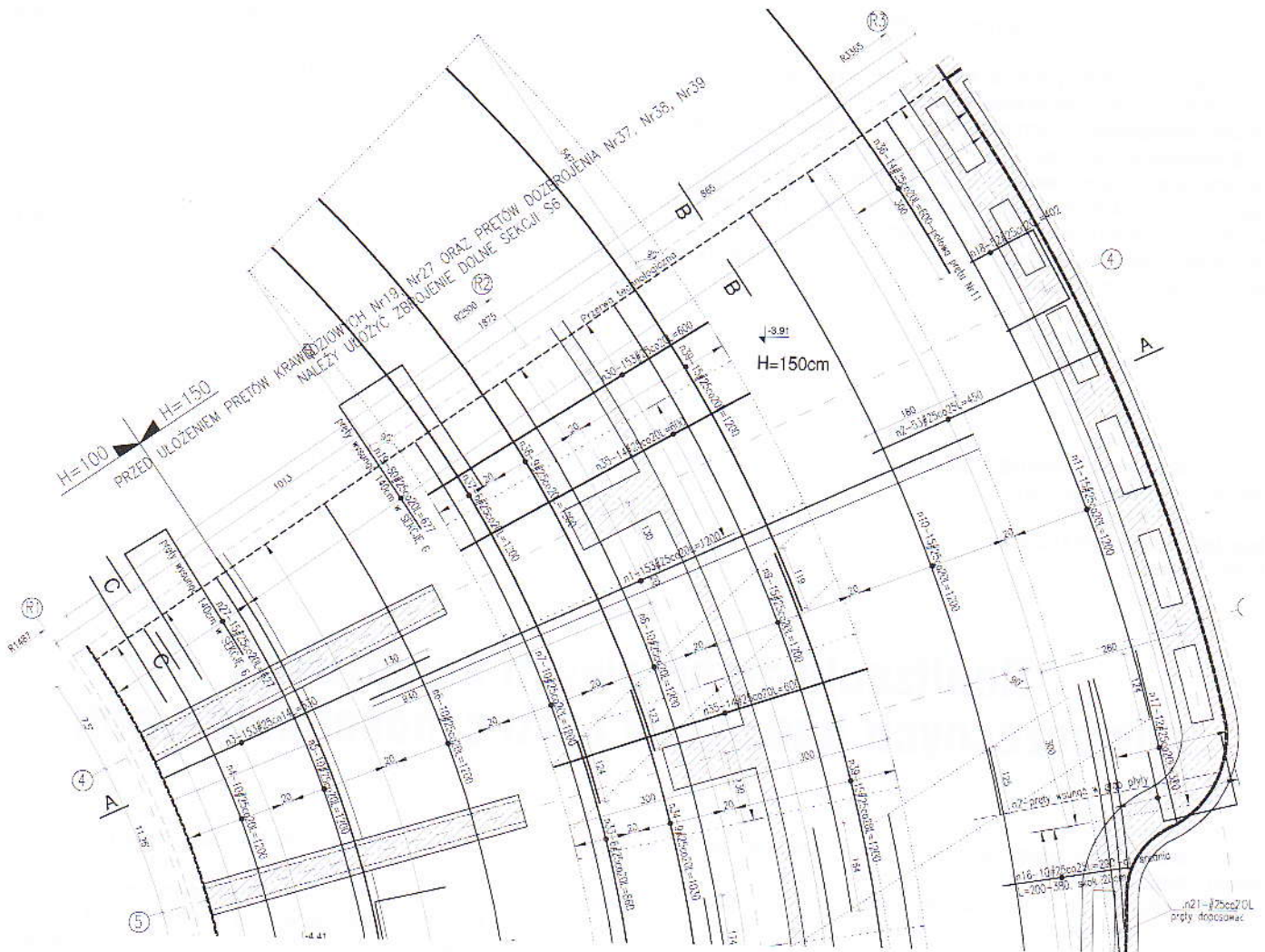
Rys. 5. Zbrojenie dolne płyty fundamentowej, sekcja 3
